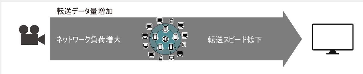
SOC社は、同社の持つ超低遅延なMPEG規格コーデック技術を4K/8Kに対応させたコーデックIPを開発し8Kボードソリューションとして提供しています。これにより、転送されるデータ量やネットワーク負荷を大幅に軽減させることができます。
